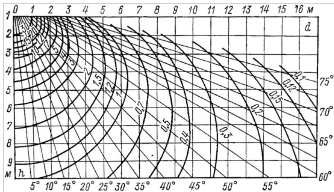
Рисунок. Пространственные изолюксы условной горизонтальной освещенности.
