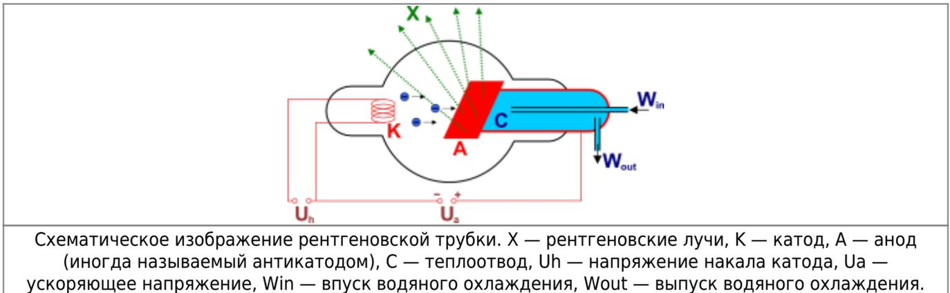
При этом за счёт тормозного излучения происходит генерация излучения рентгеновского диапазона, и одновременно выбиваются электроны из внутренних электронных оболочек атомов анода. Пустые места в оболочках занимаются другими электронами атома. При этом также испускается рентгеновское излучение с характерным для материала анода спектром энергий.
